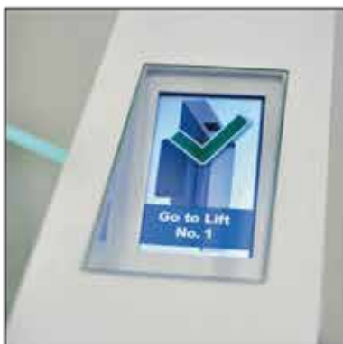
LIFT CONTROLLER - integrazione di display per indirizzamento ascensore / integration of lift controller
